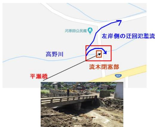
図-1 1ピア橋梁での流木集積と迂回氾濫流 (2018年7月宍粟市高野川)
