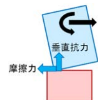
図 9 打継目上部破壊のメカニズム
