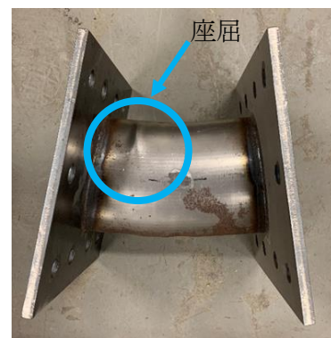
図-3 破壊状況(Major 軸実験)
