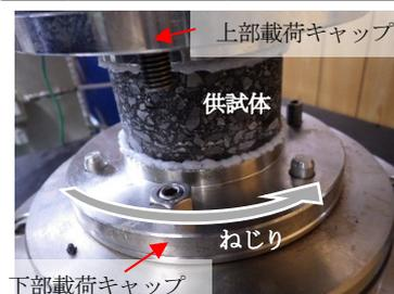
写真-1 载荷ユニットへの供試体設置状況
