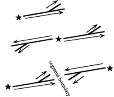
Fig.1 分岐を持つ断層の破壊方向の考え方 1)
