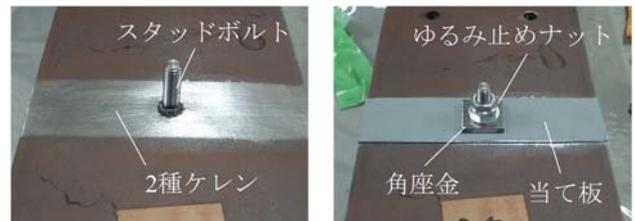
(a) 試験体 Stud (b) 試験体 Stud-Patch
