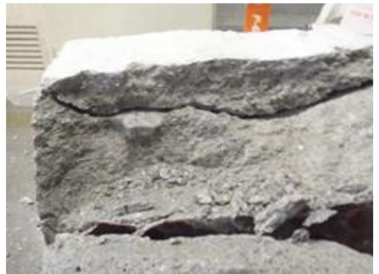
写真-1 供試体破壊面 (砂岩)
