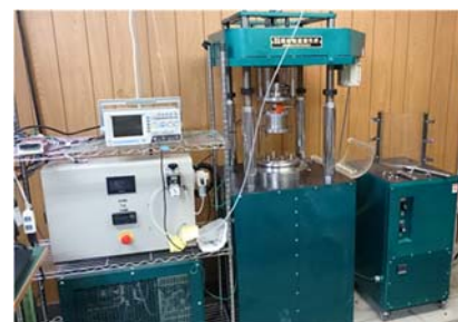
写真-1 繰返しねじりせん断試験機
