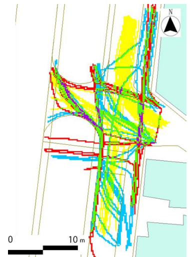
図5 流動分析 (交通が整っていない箇所)
