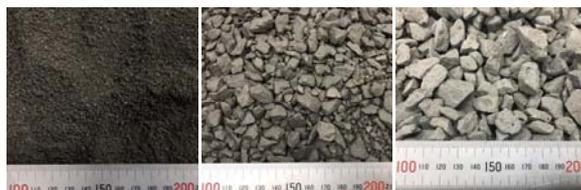
図-1 試料の外観 (左から 2 mm、9.5 mm、19 mm 試料)
