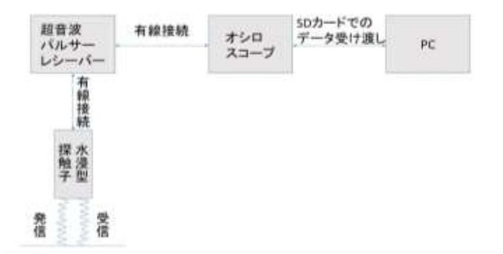
図-1 実験装置（超音波側）の構成
