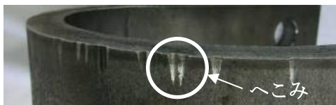
写真-1 ベローズ円筒部に生じるへこみ
