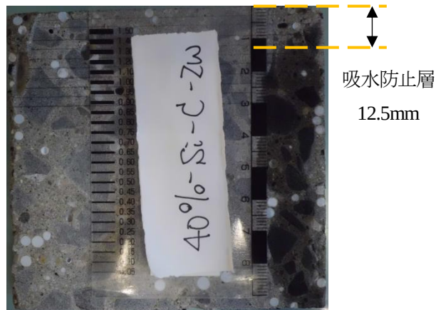
図-2 吸水防止層の形成深さ
