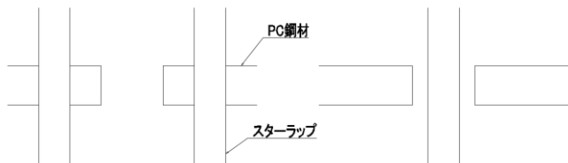
図-8 スターラップ 間で破断
