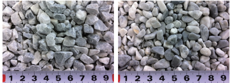
石灰岩 A (左：すり磨き前, 右：30 時間後)
