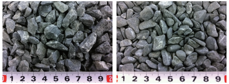
硬質砂岩 A (左：すり磨き前, 右：30 時間後)
