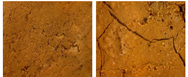
図 6. 凍結融解前後の供試体(上ノ池の表土)の様子
