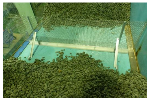
図-2 変形抑制工
