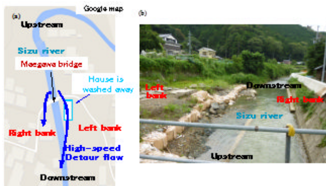
図-1 迂回氾濫流の発生による家屋の流出(2012年宇治市志津川)
