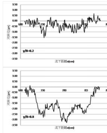
図-4 移動床部縦断形状
