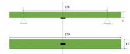
図 3 曲げ試験板の概要
