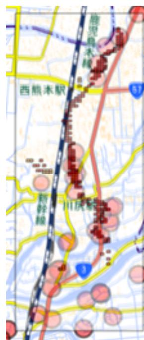
図-4 液状化と管路被害との対応
