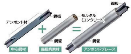
図-4 UBBの構造
