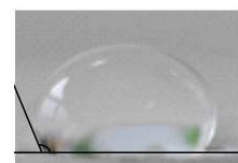
写真1 撥水性試験状況 (SAI-2 供試体面①)
