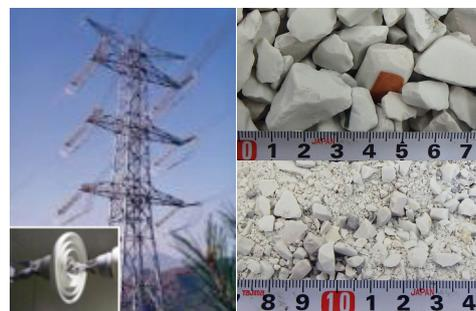
写真1 左) 碍子使用例 右上) 廃碍子粗骨材 右下) 廃碍子細骨材
