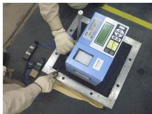
写真-2 温度および型枠影響確認試験
