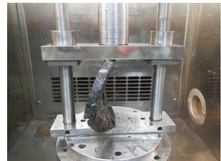
写真-1 圧裂試験状況 (StAs/10mm)
