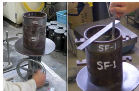
写真-1 締固め性試験
