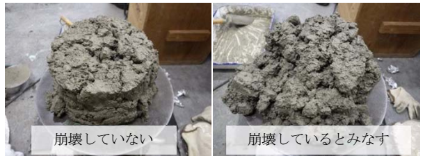
写真-3 崩壊判定の一例
