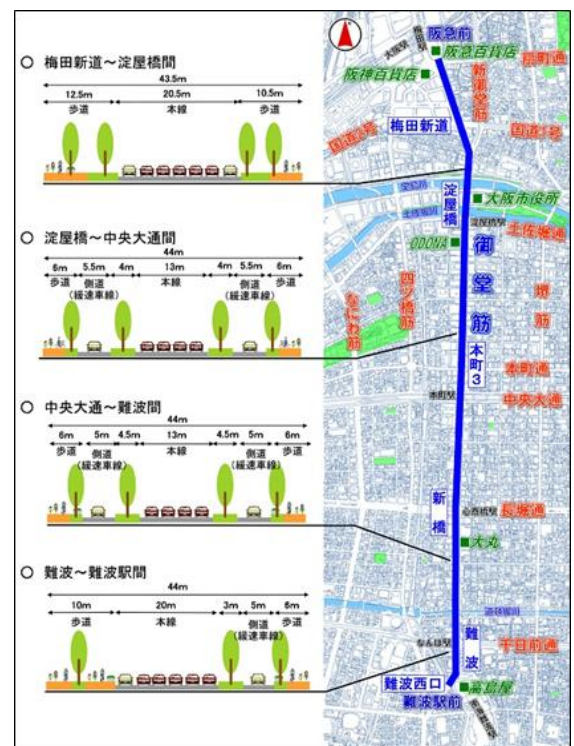
図 1 御堂筋と道路断面 3)
