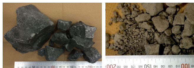
写真1 使用した岩石試料（左：硬質砂岩、右：泥岩）
