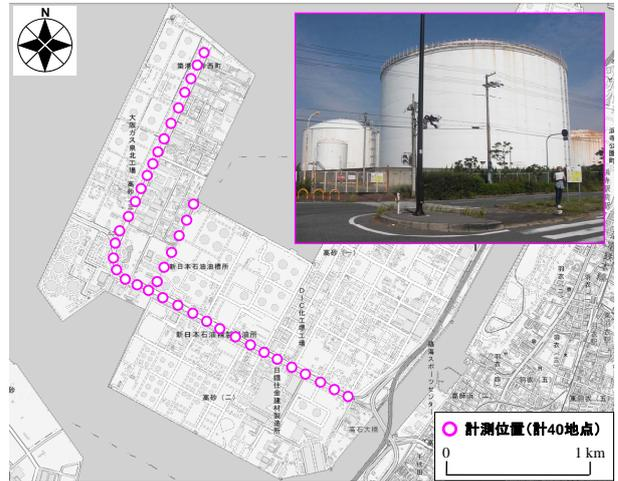
図-3 常時微動計測位置(計40地点)の分布とその実施状況
