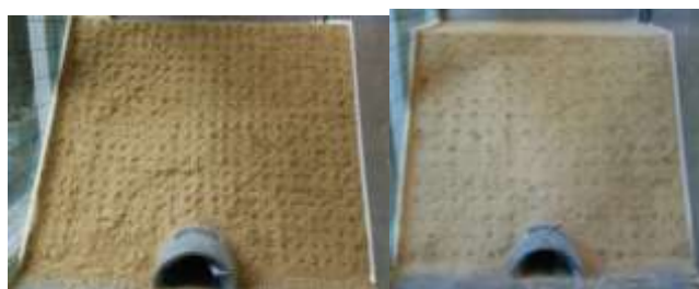
図 2 補強材設置(左：密 右：広)
