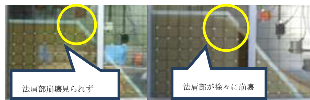
図 6 釘の設置間隔による崩壊開始の比較 (左：密 右：広)
