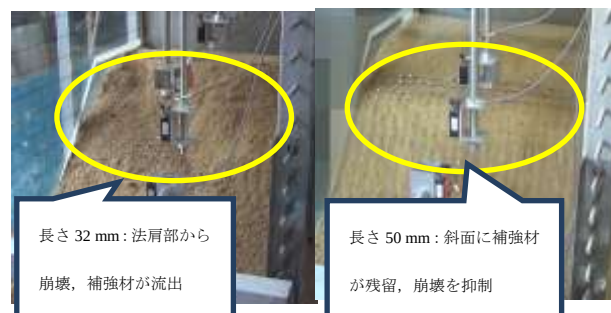
図 5 斜面に残留する補強材の本数の比較 (左：補強材長：短，右：補強材長：長)
