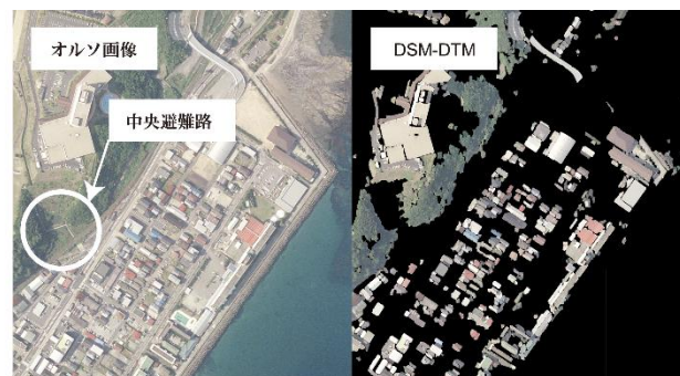
図-1 計算領域の写真測量情報
