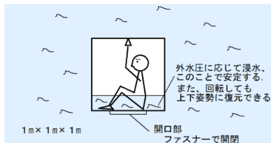
図9 1分で避難、浮上途中の津波エアバッグ
