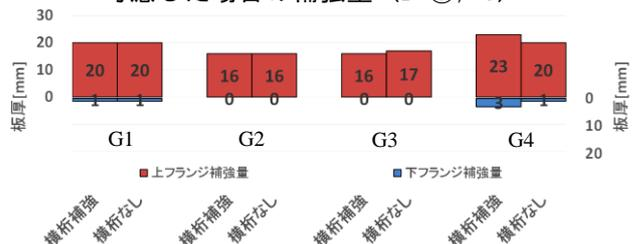
図 - 5 荷重分配横桁に着目した補強量 (D-②)
