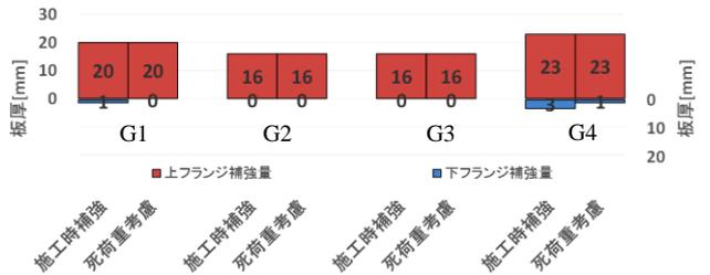
図 - 4 施工時補強および撤去側の床版死荷重を考慮した場合の補強量 (B-③, C)
