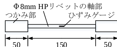
図-1 HP リベットの軸部引張試験
