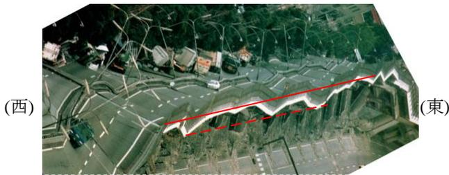
図-4 橋脚倒壊区間の航空写真<sup>16)</sup>(縦向きを横に図示)
