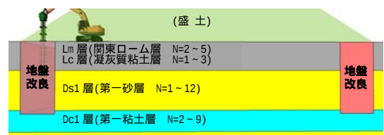
図 - 1 地盤改良概略図
