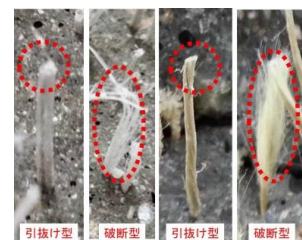
写真-1 繊維の破壊形式 (左 : PP, 右 : AR)
