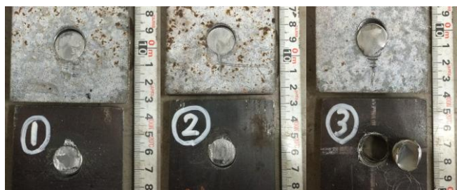
写真1 破断後の1本 TRS 試験体
