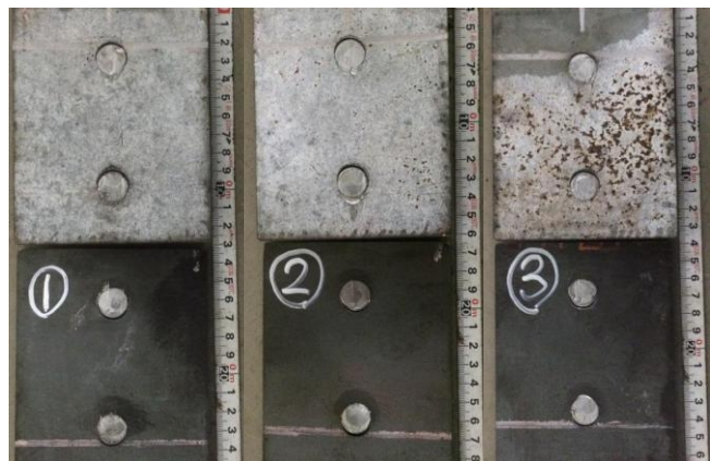
写真2 破断後の2本 TRS 試験体
