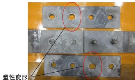
図7 接着+スタッドボルト(M16)接合の破壊状況
