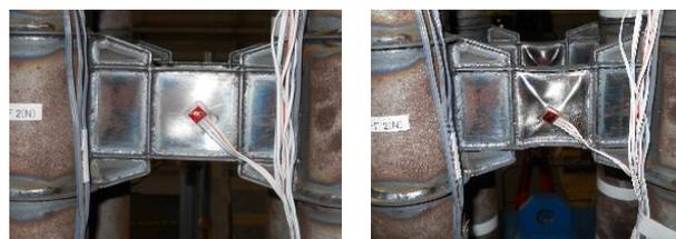
図 3 D-F の中段せん断パネルの損傷状況 (左: 第 1 加振前, 右: 第 3 加振後)
