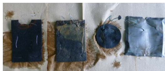
図 1 左から正極:炭素繊維(15cm×10cm)、負極:炭素繊維(15cm×10cm、微生物膜付き)、グラファイト繊維(直径 9cm、微生物膜付き)、グラファイトシート(15cm×15cm)
