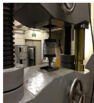
図-6 材料Bの付着強度試験結果
