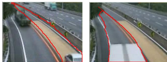
図3 通常車両の軌跡(左)と オクルージョンを補正した軌跡(右)
