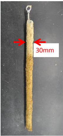
写真-1 モルタル付き杭
