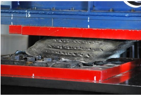
図 5. 劣化支承の終局試験における破断の状況
