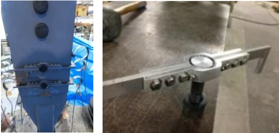
(a) 計測状況 (b) 頭部側計測治具 図-2 支圧変形計測用治具
