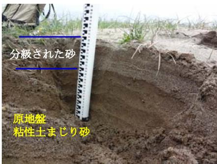
写真1 堆積土が1層の場合
