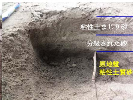
写真2 堆積土が砂質の2層の場合
