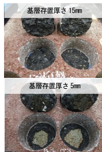
写真-2 引張接着試験後供試体
