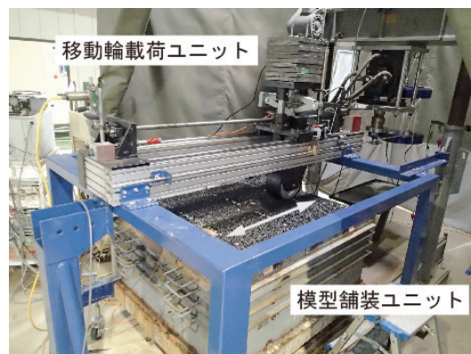
図-1 模型舗装と移動輪載荷装置
